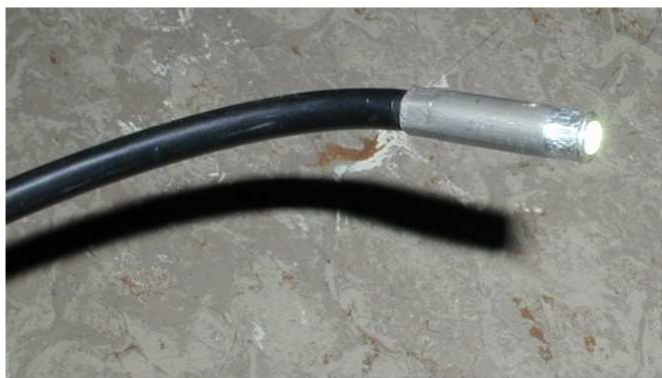
Bild 1: Reflektorlampe mit Faserbündeln und Schutzschlauch münden in den Wasserstrahler mit Linse
