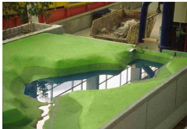
Abb. 2: Physikalisches Modell des HRB
